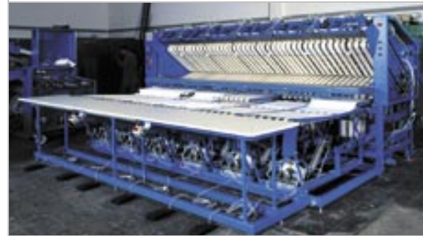
▲ ▼ Укладочная машина для крупных прачечных на 6 транспортеров: преобразователь частоты J7 обеспечивает различные скорости для разных транспортеров.
